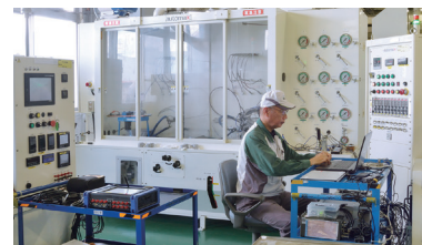
油圧試験 油圧条件:最高8MPa
