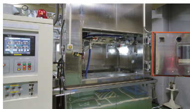
低温機能付き油圧試験 温度条件:-35℃~常温
