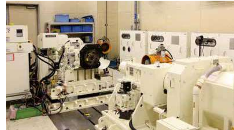
エンジン特性を模擬した各種性能、耐久実験 路面状態を再現した性能実験
