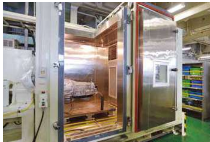
低温機能付き無負荷モーター試験機 (槽内雰囲気温度-40°C~常温)
