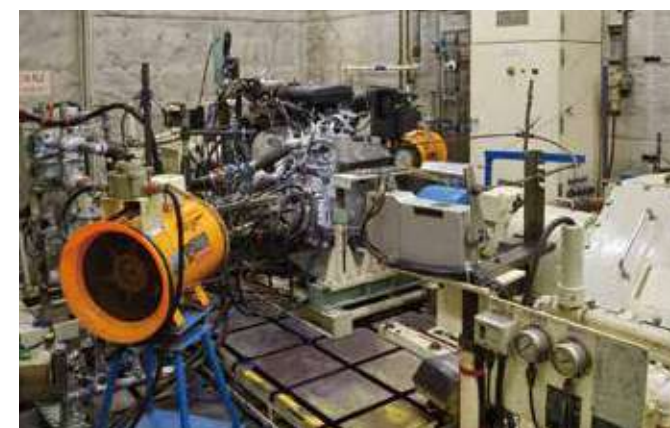
エンジンを使用した各種性能、耐久試験
