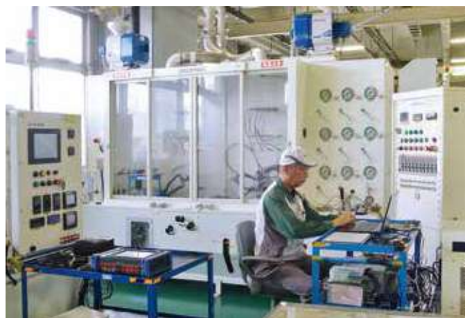
油圧試験機 最高8MPaの高油圧かつ大物部品の油圧実験が可能
