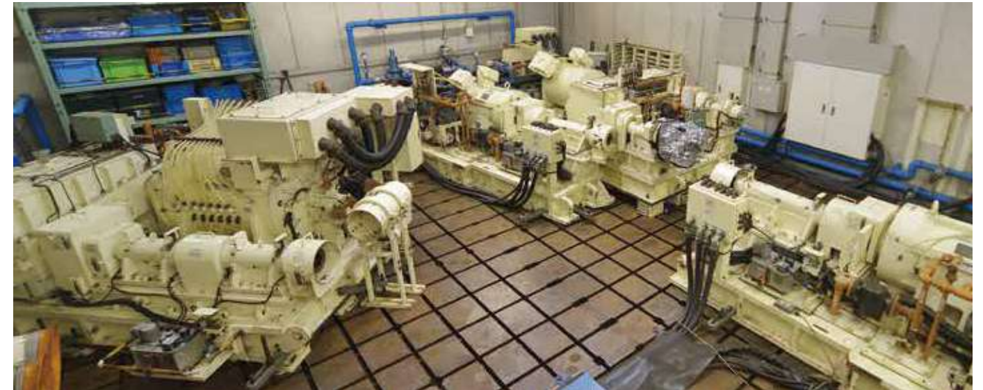
各種性能、耐久実験、フリクション測定実験
